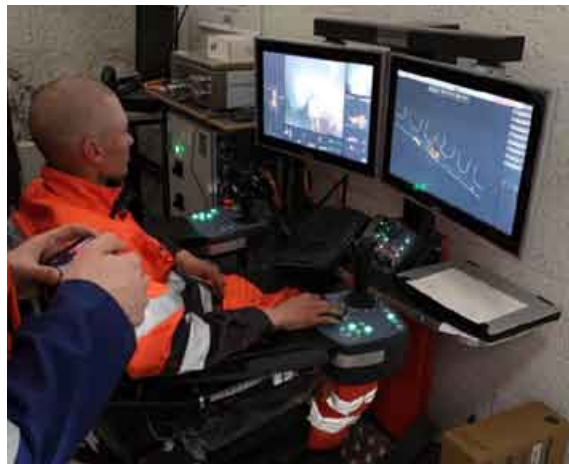
Kuva 5. Etälästausten testausta kaivoksessa 500-tasolla.
