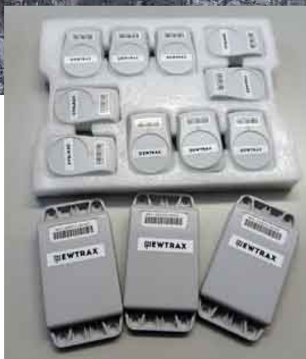
Kuva 6. Newtrax-tägejä ihmisten, laitteiden ja kulkuneuvojen paikantamiseen.
