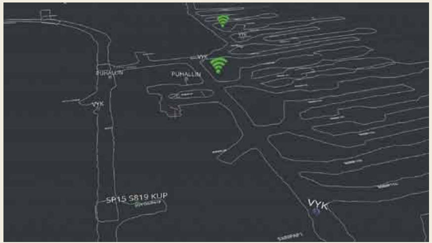
Mobilaris-ohjelmassa kartalla voidaan esittää lukuisia eri kohteita, joista käyttäjä voi valita haluamansa. Kuvassa näkyvät WLAN-tukiasemat, suojapaikat, puhaltimet ja työkoneiden virranottopistokkeet.
