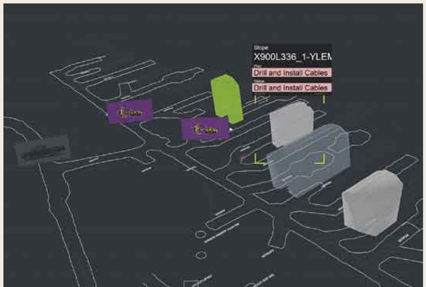
Myös työkohteet ja niiden suunnitellut työvaiheet visualisoidaan kartalla. Työvaiheet Mobilaris hakee automaattisesti kaivoksen tuotannonohjausjärjestelmästä. Kuvassa on louhos, jossa on vaijerointi käynnissä.
