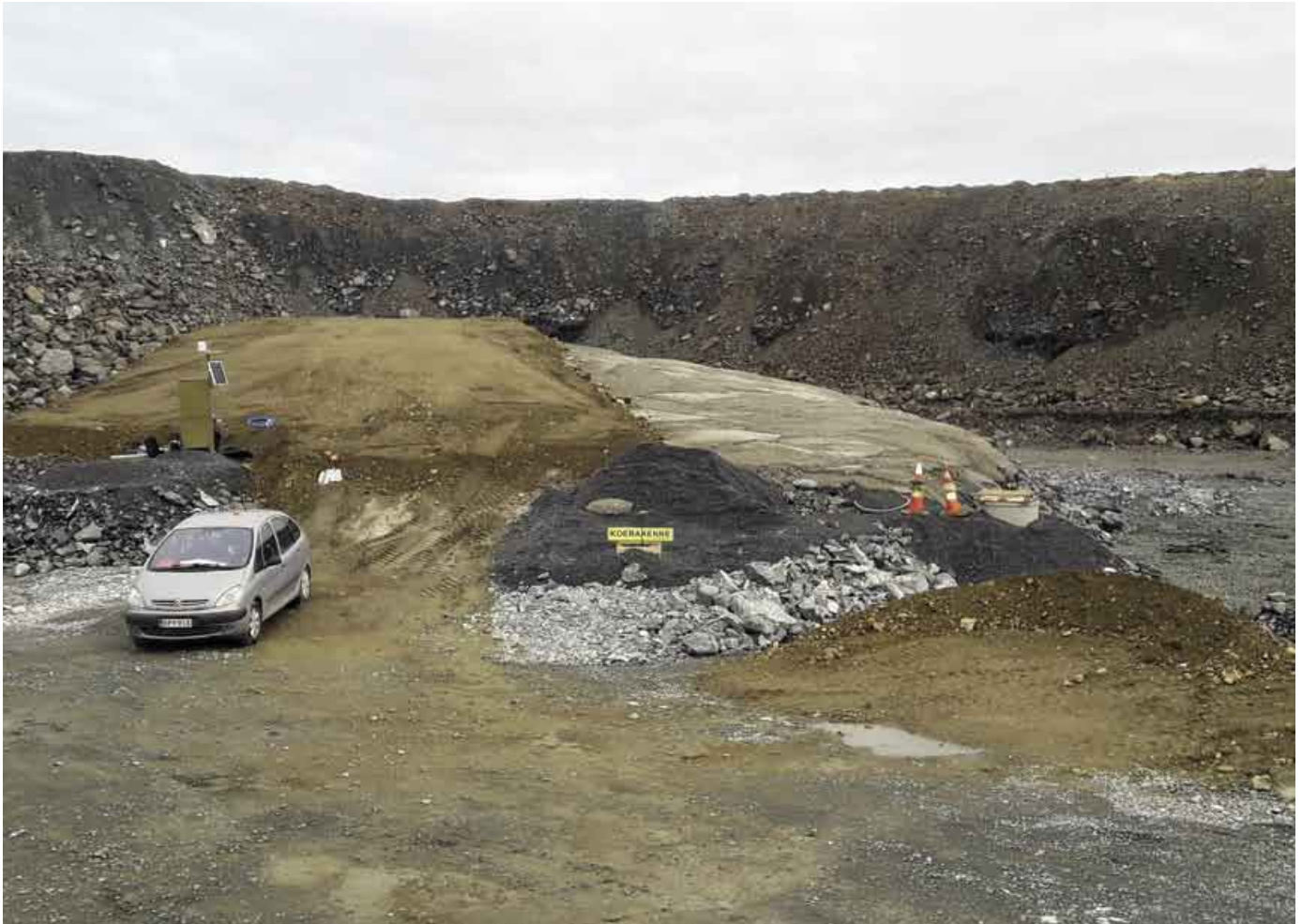
Kuva 2. Tapojärvi Oy:n toteuttama geopolymeerikoerakenne Kittilän kultakaivoksella
