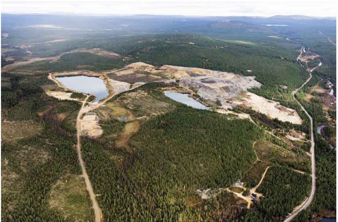
Kuva 3. Hannukaisen alueella on ollut aiempaa kaivostoimintaa, jonka jäljiltä alueella on kaksi vanhaa avolouhosta ja sivukiven sekä pintamaiden läjitysalueet.
