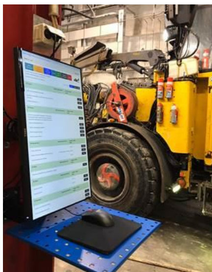
Kuva 7. eHuoltolista-ohjelmisto valmiina kaivoskoneen säännöllisten huoltotoimien kirjaamista varten.
