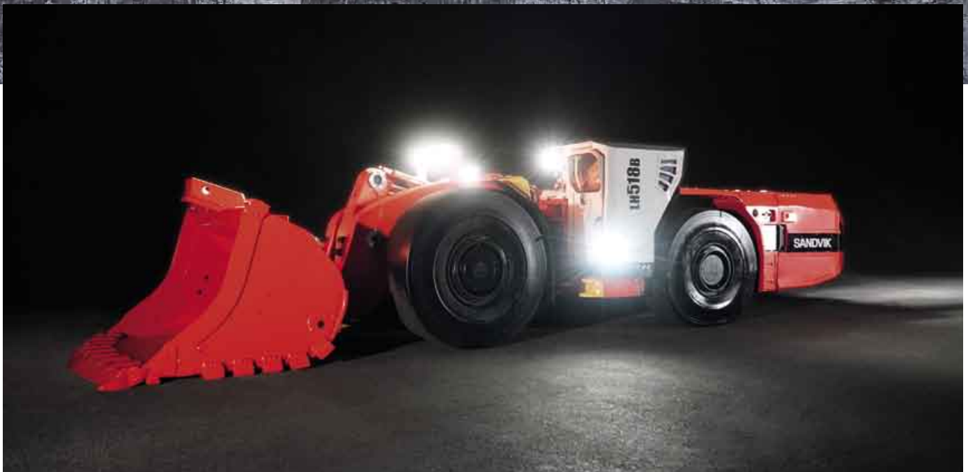
Sandvik lanseerasi syksyllä 2020 LH518B-lastauskoneen, joka on maailman ensimmäinen 18 tonnin kantokyvyn akkukäyttöinen lastauskone maanalaisiin kovan kiven kaivoksiin.
